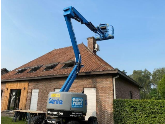
Telescopische hoogwerker. Ook wel “verreiker” of Manitou genoemd.
