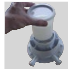
Installatie van de terugslagklep binnenin het mondstuk
